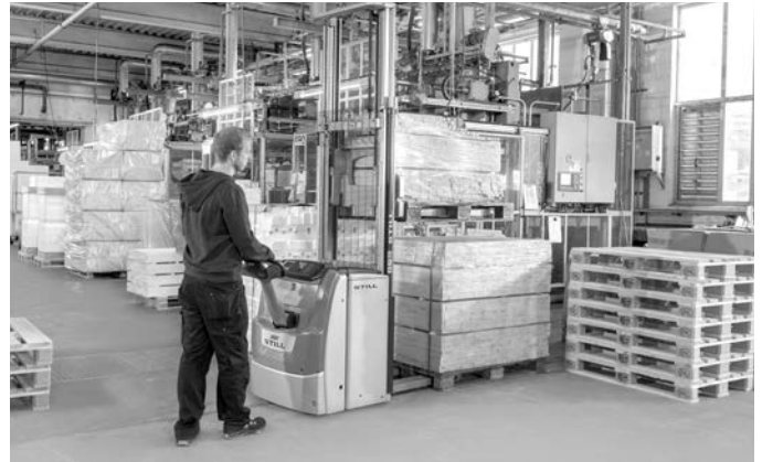
Hoge omslagcapaciteit dankzij het gelijktijdig vervoeren van 2 niet stapelbare pallets
