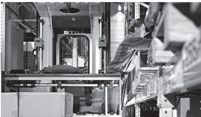
Kantelbeveiliging voor het ergonomisch orderpicken tot het einde van de pallet
