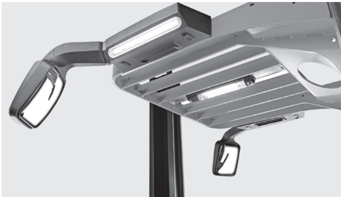
Individueel instelbare achteruitkijkspiegel voor het eenvoudig injrijden in smalle gangen
