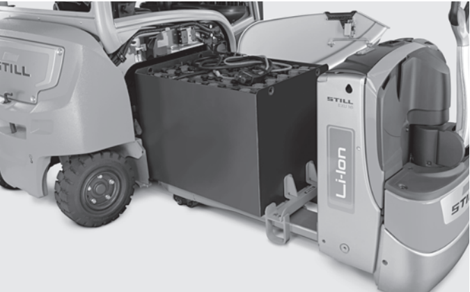
Batterij verwisselen met elektrische pallettruck
