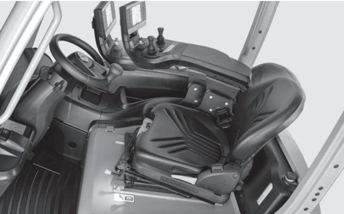
Draaistoel voor comfortabel achteruit rijden
